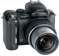
Variogon с 12-кратным оптическим зумом. За отсутствие «шевеленки» будет отвечать оптический стабилизатор. Инженеры установили в камеру матрицу типоразмера 1/2,5" с 7,1 млн эффективных пикселей, что позволяет получать снимки с разрешением 3072 х 2304. Дополнительную скорость и точность фокусировки обеспечит гибридная система автофокусировки, которая работает как в пассивном, так и в активном режиме. Продажи новинки в Европе начались в середине
