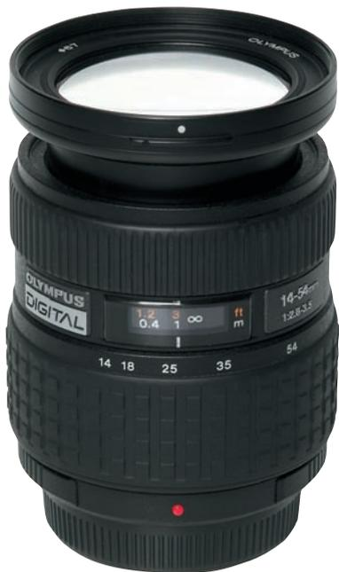
Olympus 14–54 мм f/2,8–3,5 — зум среднего класса, имеет переменную светосилу, защищенный корпус и металлический байонет. В пересчете его фокусное расстояние эквивалентно 28–108 мм. Несмотря на высокую светосилу, объектив не выглядит громоздким. В оптической схеме присутствуют три асферических элемента, минимальная дистанция фокусировки составляет 22 см.
