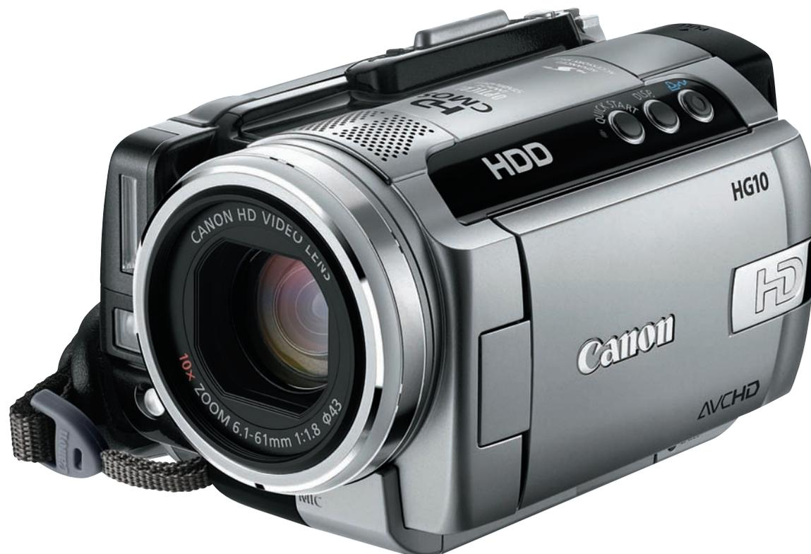
Canon представил свой первый HD-камкордер на базе жесткого диска. HG10 пишет видео в формате AVCHD на встроенный 40-Гб жесткий диск, которого хватает на 5,5 часа записи в максимальном качестве.
